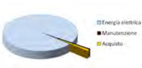
Fig. 2 - ripartizione costi acquisto e gestione di un motore elettrico
